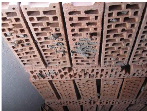
Figuur 2: Deze geperste stenen moeten worden ingesmeerd met een dunne klei-pap met zand om ruwer te worden. Het is ook mogelijke gewone bakstenen te nemen en daarin gaten van 3 cm doorsnee en 8 cm diepte boren.
