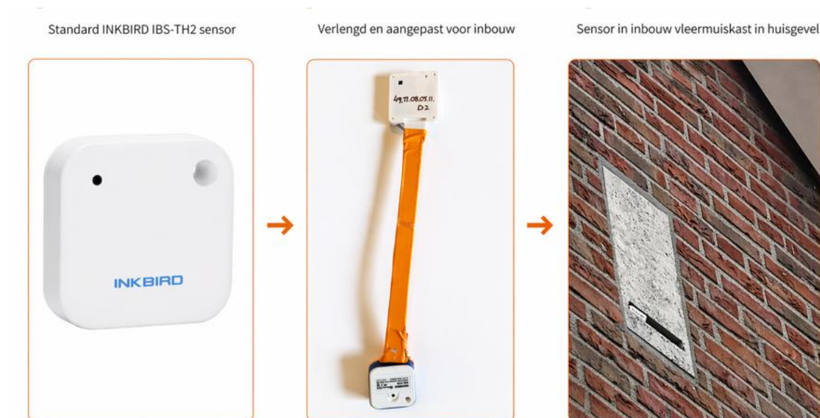
Figuur 1. INKBIRD IBS-TH2 sensoren voor temperatuur en luchtvochtigheidmetingen in vleermuiskasten; van links naar rechts de originele sensor, de aangepaste sensor voor het plaatsen in vleermuiskasten en een voorbeeld van een ingebouwde sensor.
