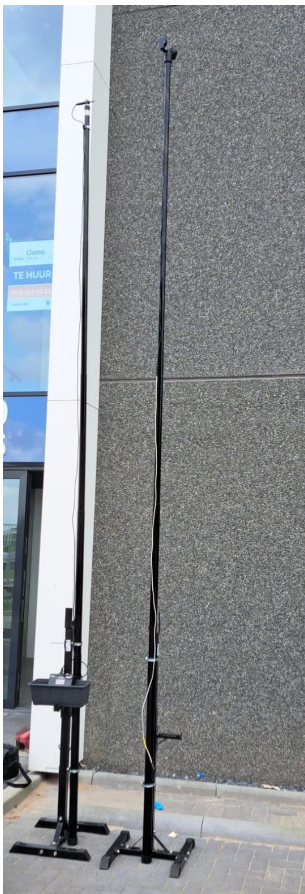
Afbeelding 2.2 | De setup van de materialen. De microfoon bij de opname en de luidspreker bij afspelen zijn gemonteerd op een paal die op ca. 5 meter kon worden gebracht.
