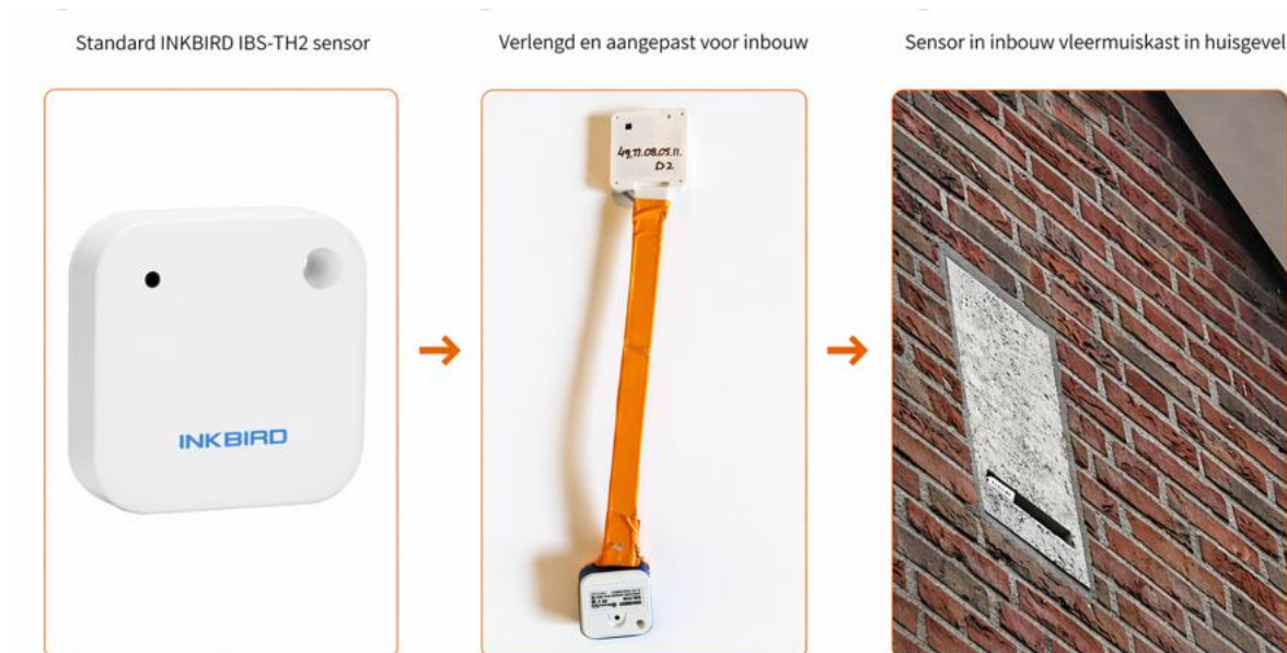
Figuur 1. INKBIRD IBS-TH2 sensoren voor temperatuur en luchtvochtigheidmetingen in vleermuiskasten; van links naar rechts de originele sensor, de aangepaste sensor voor het plaatsen in vleermuiskasten en een voorbeeld van een ingebouwde sensor.
