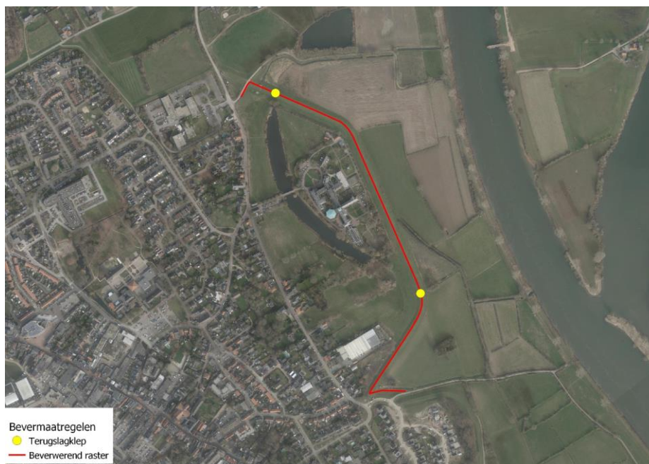
Figuur 1. De ligging van het beverwerend raster aan de westzijde van het terrein van Julie Postel, inclusief de twee terugslagkleppen.
