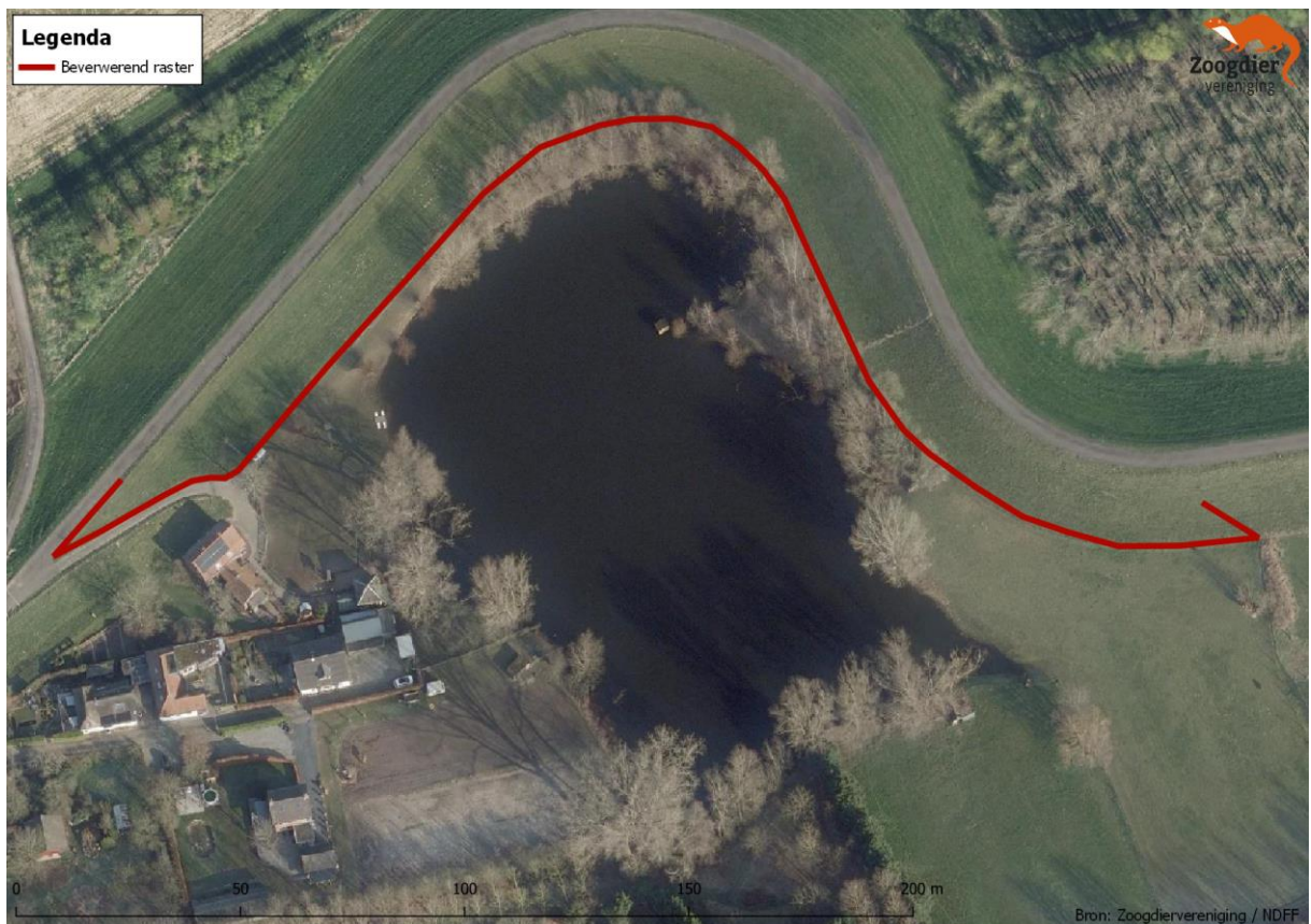
Figuur 2. Locatie beverkerend raster om te voorkomen dat nieuwe bevers zich vestigen na het euthanaseren van de bevers in het Oude Wiel. Aan de uiteinden van het raster wordt een teruglopend deel toegepast (een soort fuik) om te ontmoedigen dat de bevers er omheen lopen.
