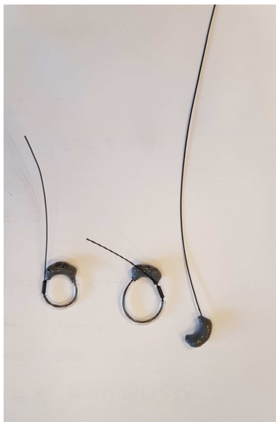
Figuur 2.2 De Holohil BD-2C zender (foto: P. Lemmers)
