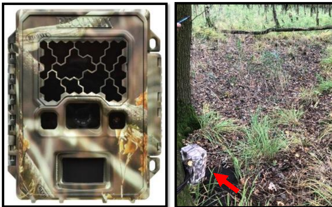
Figuur 8a (links): Reconyx Hyperfire Wildcamera. Bron: Wildlife Monitoring Solutions, z.d. Figuur 8b (rechts): Wildcamera op een hoogte van 50cm aan een boom gebonden. Kijkt uit op een wildwissel.
