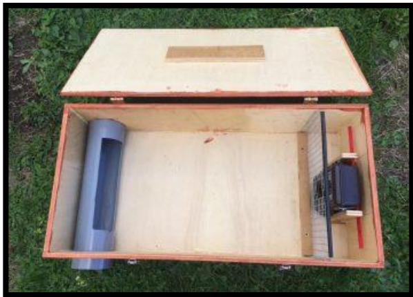
Figuur 6a (links): Bovenaanzicht van de Mostela van Jeroen Mos in het veld. Figuur 6b (rechts): Mostela geplaatst in het veld. De pijl duidt de locatie aan. De sporenbuis van de Mostela staat aan de rand van de houtwal.
