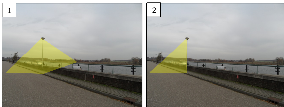
Figuur 5. Een voorbeeld van het verbeteren van de verlichting. Met goede armaturen kan de lichtbron worden gebundeld, waardoor alleen de elementen verlicht worden die gewenst zijn (in dit geval straat de Schoor).
