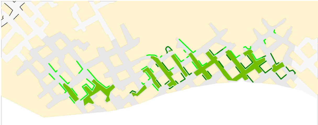
Figuur 63: De mate van algengroei in zone AB; lichtgroene lijn: wand geheel begroeid met algen. Donkergroene lijn: alleen bovenaan de wand begroeid met algen. Groene vlak: plafond begroeid met algen.
