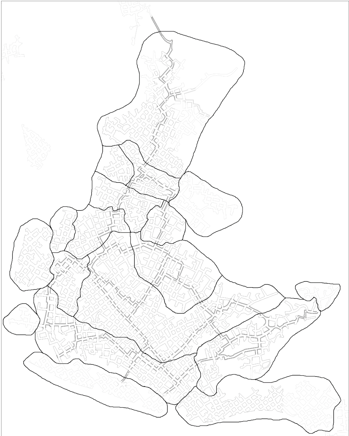
Figuur 3: Vooraf ingeschatte klimaatzones. Grenzen zijn bepaald aan de hand van flessenhalzen (smalle doorgangen tussen delen van het stelsel).
